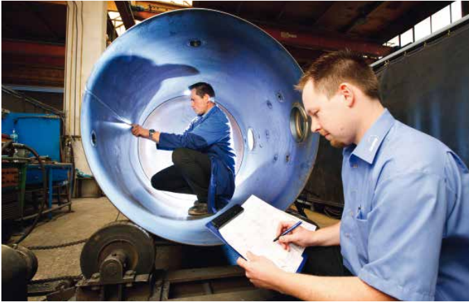
Abnahmebegutachtung eines Druckgerätes
