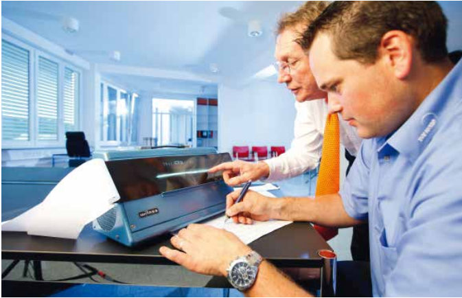
Begutachtung des Röntgenbildes einer Schweißnaht
